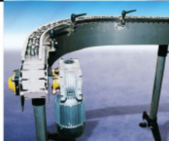
Kurvenförderband KFB 400 mit hochverschleißfestem Kunststoffgliedergurt für Stahlteile. Ausführung mit verstellbarer Seitenführung und Untergestell, Bandgerüst in Edelstahl
